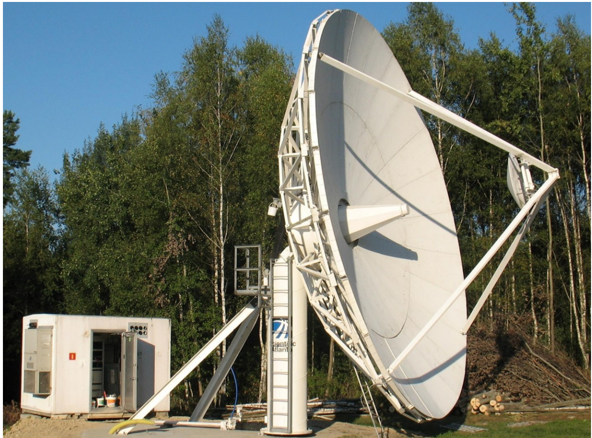
RT-9 z Psar zbudowany na nowo w Rzepienniku Biskupim. Instrument został wykonany przez amerykańską firmę Scientific Atlanta w roku 1999. W 2010 został zdemontowany w Psarach przez Bogdana Wszółka i przez niego zbudowany na nowym miejscu w 2012. (fot. B. Wszółek)
