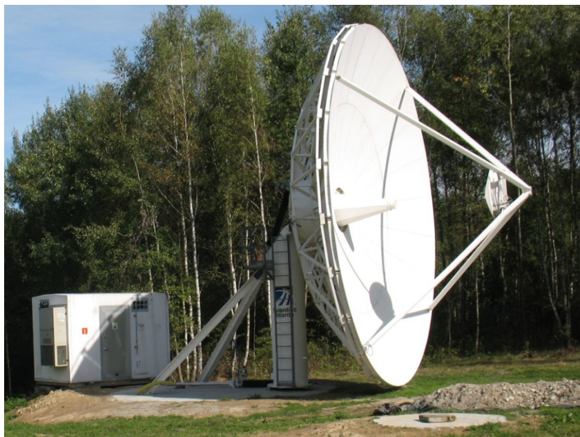
Radioteleskop RT-9 zbudowany przez dr. Wszółka w Rzepeinniku Biskupim. (fot. B. Wszólek)
